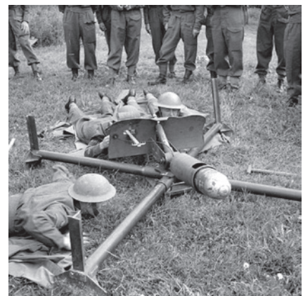
En Blacker Bombard i den "rörliga" utformningen.
