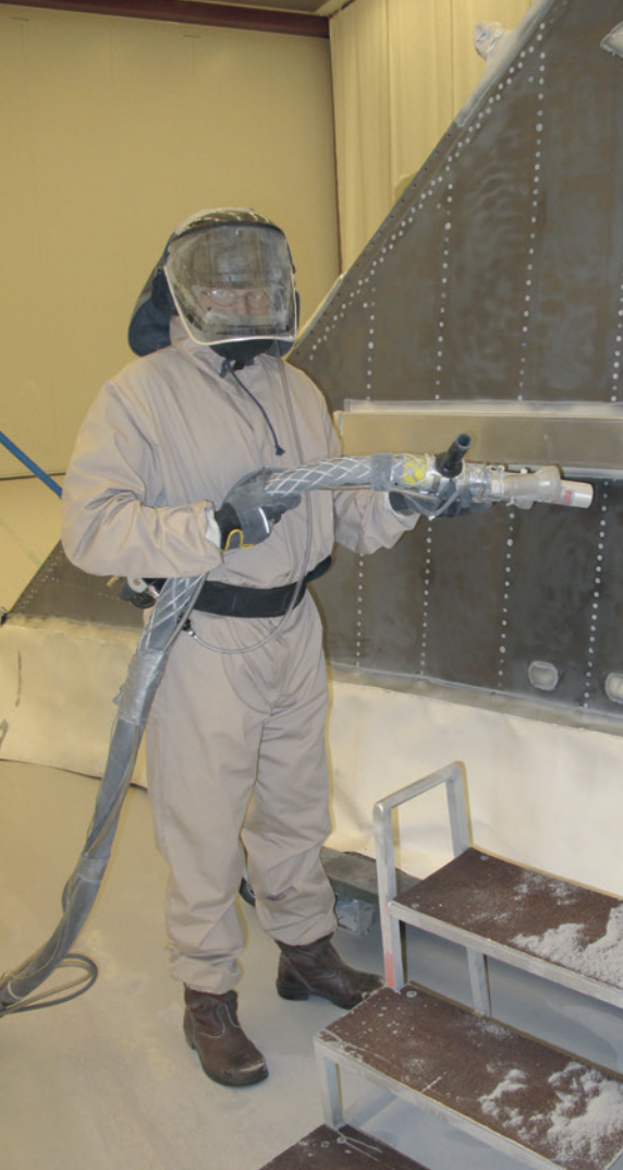
Bild 3. Utrustning vid blästerarbete görs med heltäckande bomullsoverall och friskluftsmask
