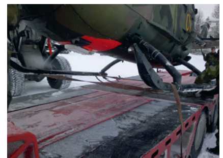
Justering av bredden på landstället med hjälp av spännband.
