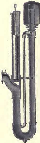
Kisnyomású gőzkazán égés- szabályozóval kapcsolt biztosító csőve.
