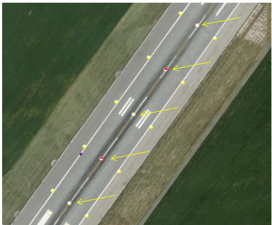
T.v. Markeringslys for senterlinje T.h. Markeringslys for senterlinje med 60 meters avstand på Kristiansand lufthavn, Kjevik (CAT I)
