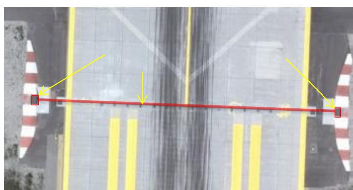
Arresting gear (stop wire) på Bodø lufthavn. Røde linjer skal registreres (både vaieren og festeanretning). Festeanordningen i endene skal registeres som flate.
