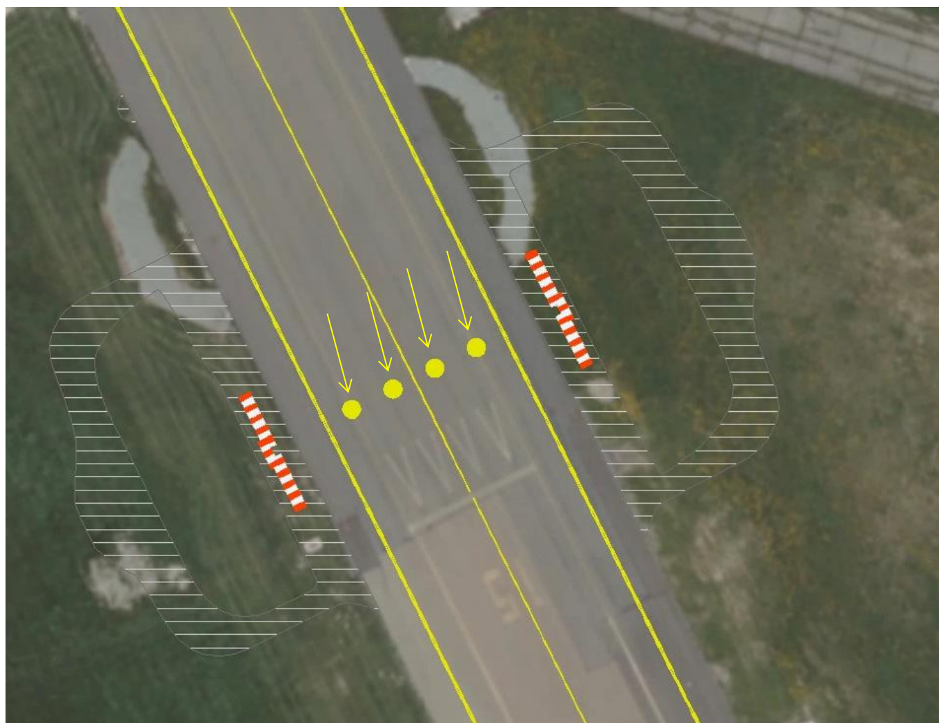
Eksempel på Arresting gear Merking på Ørland lufthavn.
