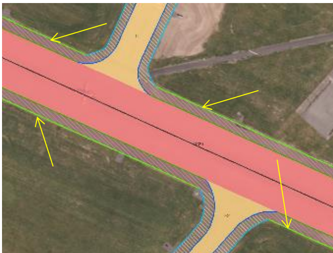
Rullebaneskuldergrense (her markert i grønt) ved Stavanger lufthavn, Sola. Her avsluttes Rullebaneskuldergrensen der den treffer Taksebaneskulderflaten. Er det ikke Taksebaneskulder, avsluttes Rullebaneskuldergrensen i Taksebanen.
