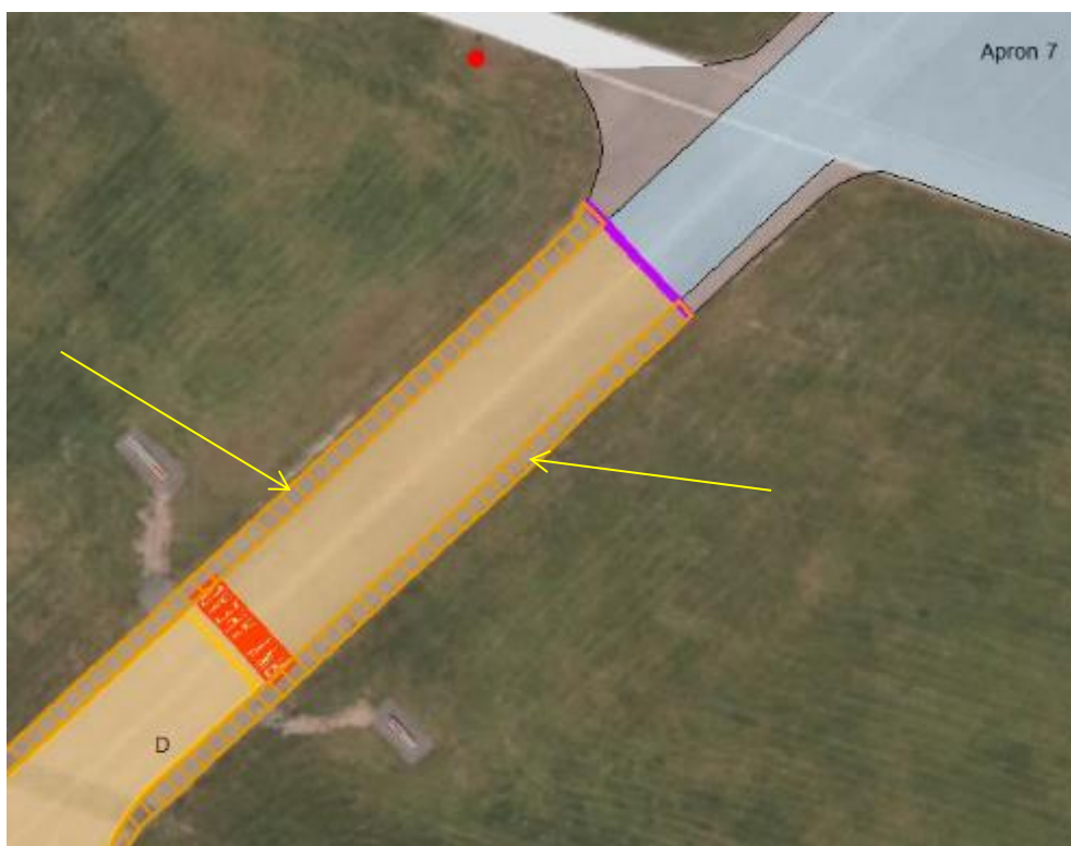
Taksebaneskulder og Taksebaneskuldergrense registreres fram til Grense for manøvreringsområde (her markert i lilla). Eksempel fra Stavanger lufthavn, Sola.
