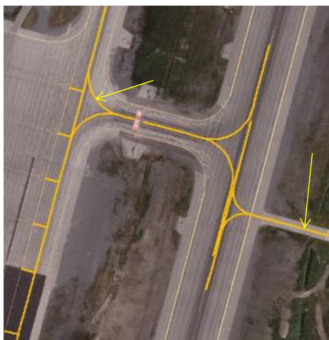
T.v. Senterlinje (taksebane) på Tromsø lufthavn, Langnes T.h. Skisse forsterket senterlinje taksebane
