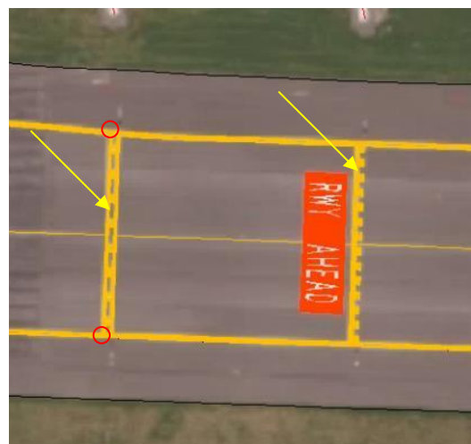
T.v. venteposisjon på Kristiansund, Kvernberget T.h.venteposisjoner (type A og type B) på Stavanger lufthavn, Sola
