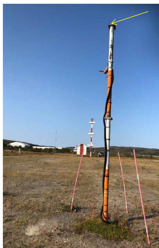
Eksempel på GP-nærfeltmonitormast på Kirkenes lufthavn, Høybuktnoen
