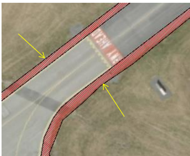
T.v. PlanertLufthavnarealgrense er ytterkant av det som her er markert i rød skravur langs en taksebane på Stavanger lufthavn, Sola. Taksebane kategori B
