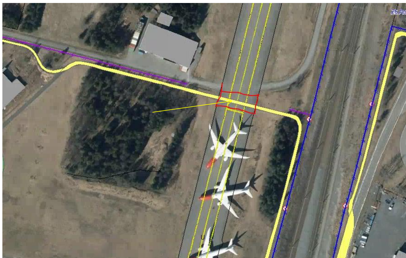
Gjerdeinspeksjonsvei i gult på Oslo lufthavn, Gardermoen. Legges inn som objtype ANNENLUFTHAVN der den går over baneflater.
