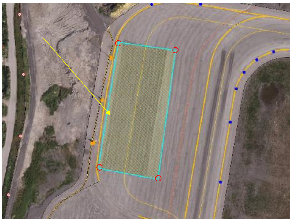
Mulig avisingsplattformoppmerking markert med lyseblå kantlinje på Tromsø lufthavn, Langnes
