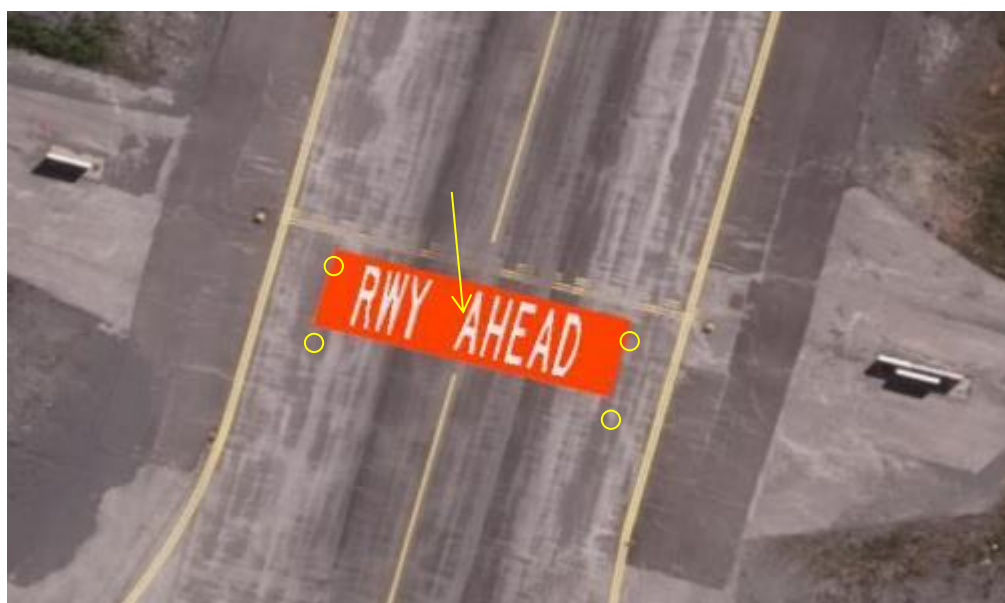
Instruksjonsmerking på Tromsø lufthavn, Langnes (bildet er rotert) Andre former for instruksjonsmerking kan forekomme.
