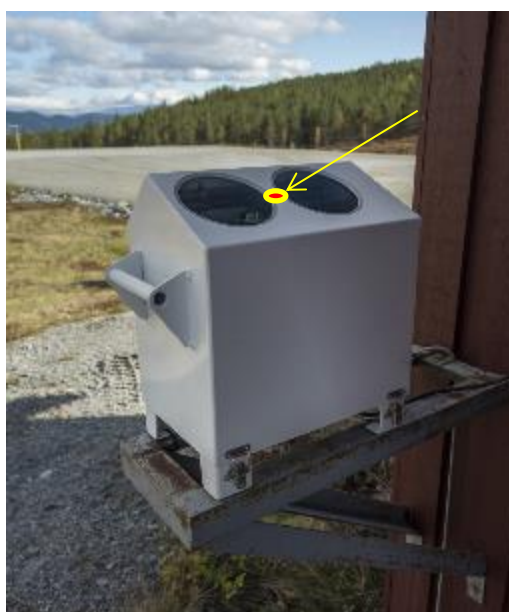
Skyhøydemåler på Sogndal lufthavn, Haukåsen
