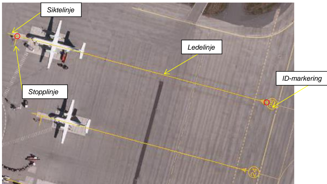
Eksempel på ledelinje, ID-markering, siktelinje og stopplinje på Tromsø lufthavn, Langnes
