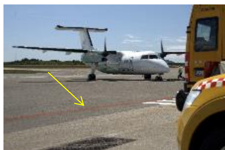
T.v. eksempel på sikkerhetslinje rundt helikopteroppstillingsplass
