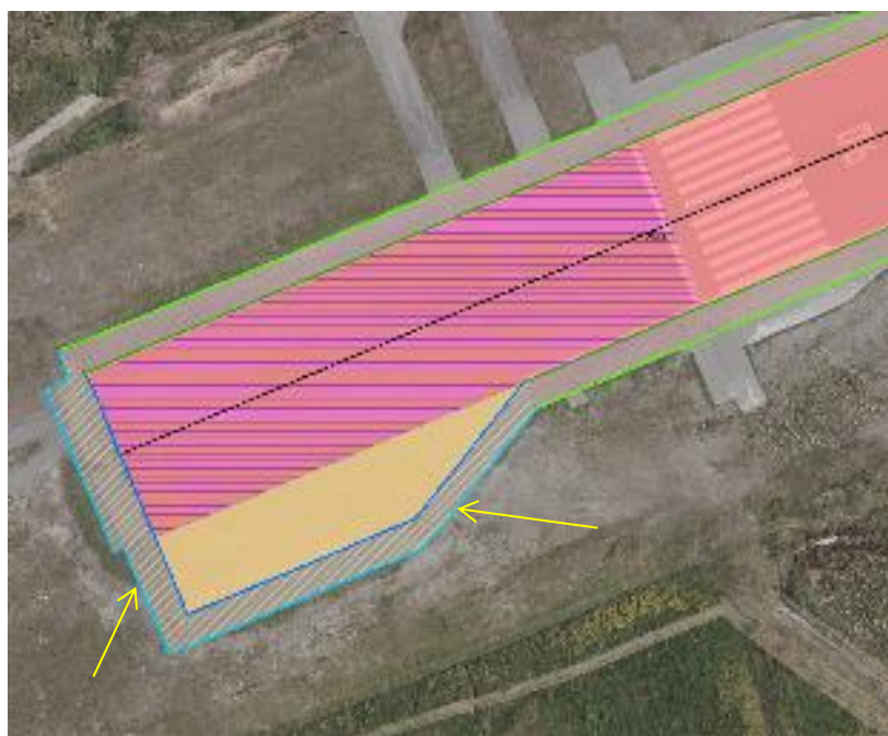
Rullebanesnuplasskuldergrense (markert med lyseblått) på Ålesund luftan, Vigra
