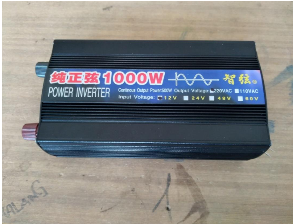
Gambar 3. 6 Inverter Sumber : Penulis, 2022
