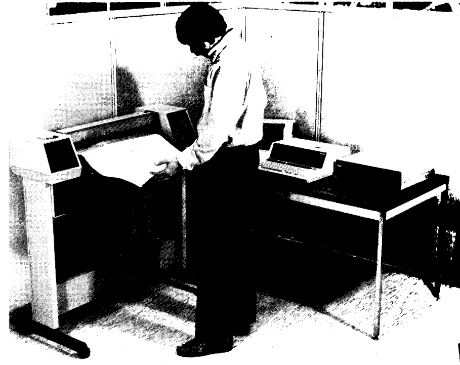
Gambar 13-3. Komputer-meja yang dapat diprogram untuk hitungan pengukuran dirangkai dengan mesin penggambar otomatis. (Atas kebaikan Hewlett-Packard Co.).
