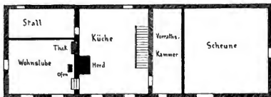
Grundriss eines Eifelhauses. Erdgeschofs.
