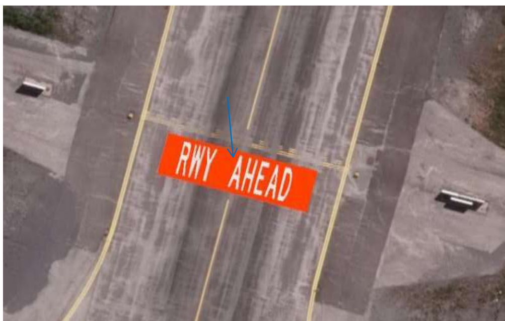
Instruksjonsmerking på Tromsø lufthavn, Langnes (bildet er rotert) Andre former for instruksjonsmerking kan forekomme.
