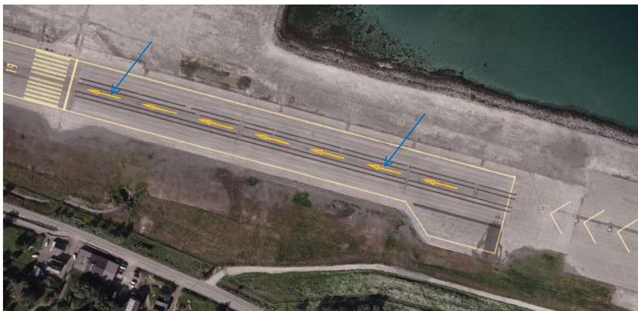
Piler for innflyttet terskel på Tromsø lufthavn, Langnes (bildet er rotert)
