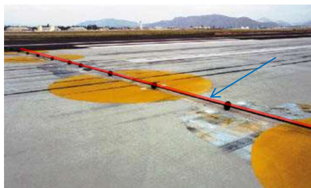
Arresting gear (stop wire) på Bodø lufthavn. Røde linjer skal registreres (både vaieren og festeanretning).
