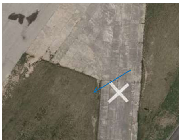
Eksempel på instruksjonsmerking på Kristiansand lufthavn, Kjevik. Andre former for instruksjonsmerking kan forekomme.
