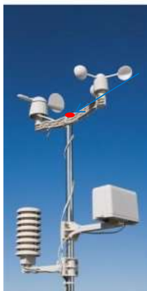
Eksempel på automatisk målestasjon
