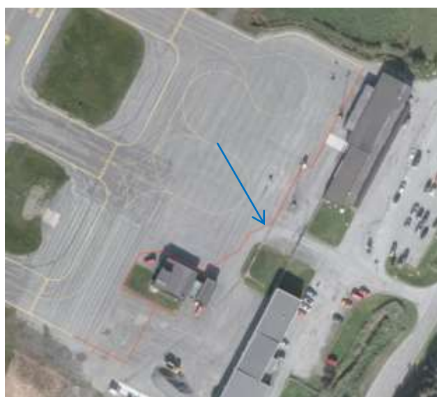
T.v. eksempel på sikkerhetslinje på Sandnessjøen lufthavn, Stokka T.h. eksempel på sikkerhetslinjer rundt oppstillingsplass og parkering forbudt-områder på OSL, Gardermoen
