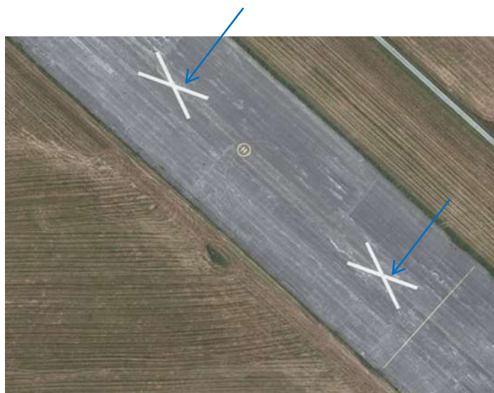
Eksempel på instruksjonsmerking på Trondheim lufthavn, Værnes. Andre former for instruksjonsmerking kan forekomme.
