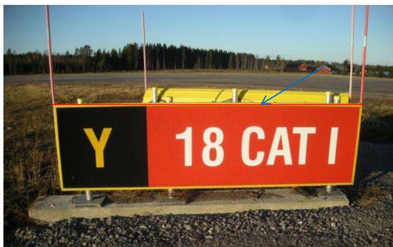
Venteposisjon presisjonsrullebane på Sandefjord lufthavn, Torp
