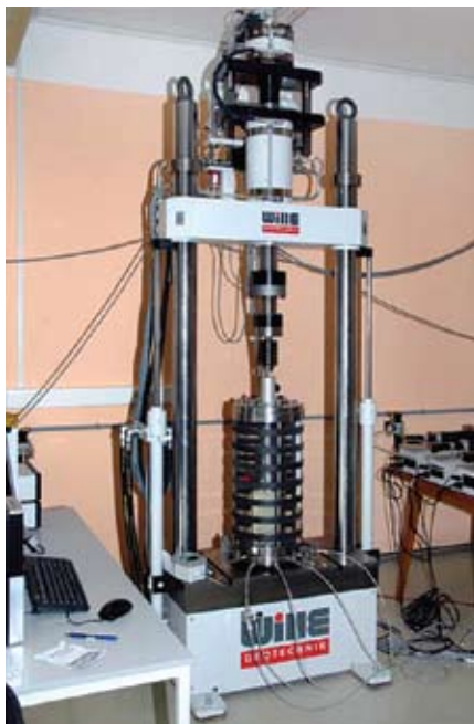
Dinamični torzijski triosni aparat na Zavodu za gradbeništvo Slovenije
