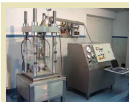
Na sliki 1 je prikazana stiskalnica s spremljajočo opremo za vodenje in registriranje parametrov raziskave, na sliki 2 visokotlačna triosna celica in na sliki 3 rezultati triosne ciklične strižne raziskave laporja.
