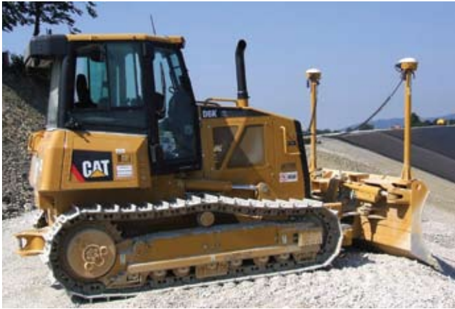
Prikaz AccuGrade na buldozerju D6K XL, v ozadju položena tamponska plast čaka na asfaltno tesnjenje in sanacija ploskovnega zdrsa na flišni brežini bodočega bazena
