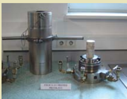
Na sliki 1 je prikazana stiskalnica s spremljajočo opremo za vodenje in registriranje parametrov raziskave, na sliki 2 visokotlačna triosna celica in na sliki 3 rezultati triosne ciklične strižne raziskave laporja.
