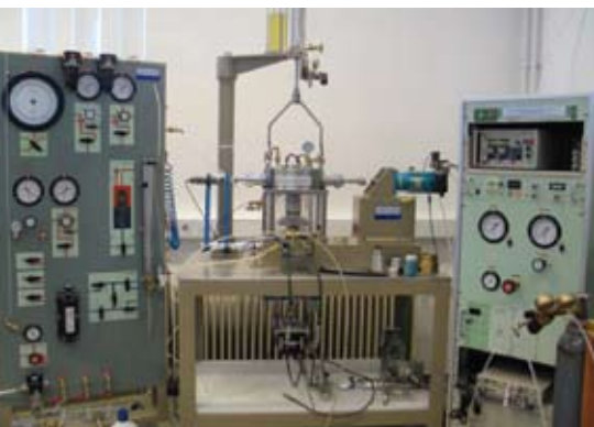
Ciklični čisti strižni aparat DTA-136
