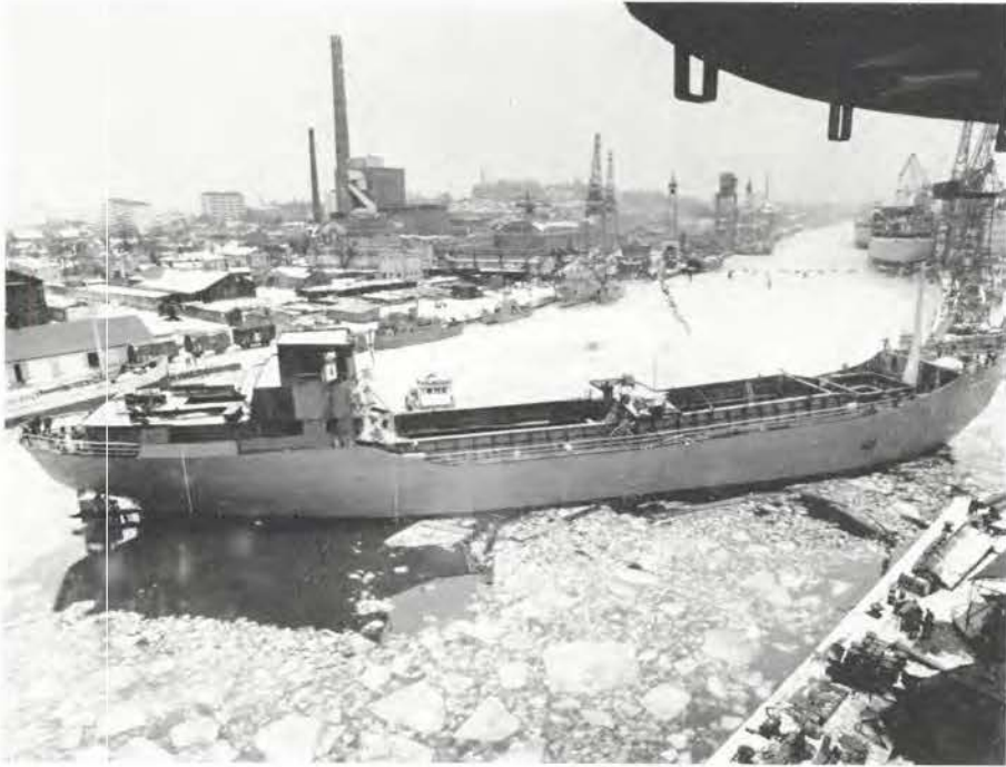
M/s Malmvik, bolagets senaste fartygstillskott för cementtransport, sjösattes den 30 januari 1964. Fartygets dimensioner är de samma som m/s Granviks, d.v.s. 90,8 m:s längd och 12,4 m:s bredd, och dess automatiska lastnings- och lossningsutrustning blir liknande.
