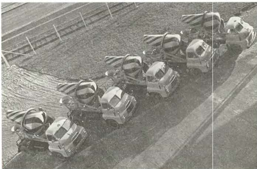
En del av den bilpark, som betongstationen i Helsingfors har och som sörjer för en effektiv distribution av färdigblandad betongmassa.
