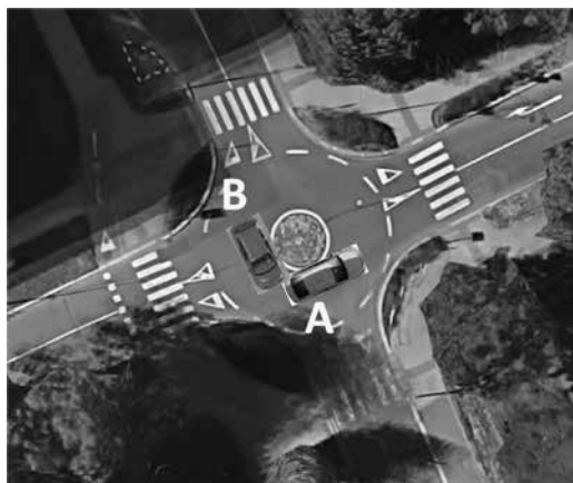
Obr. 7.: Mini okružní křižovatka na ul. Dr. Malého – pravděpodobný střet vozidel (Zdroj: Mapy.cz [2] – upraveno)
