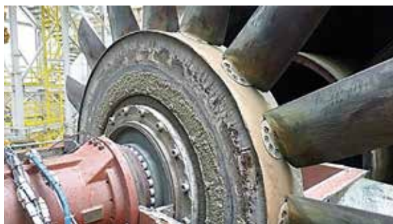
FOT. 3 Zdemontowany wirnik (A) widok z przodu, (B) charakterystyczne miejsca dezintegracji
