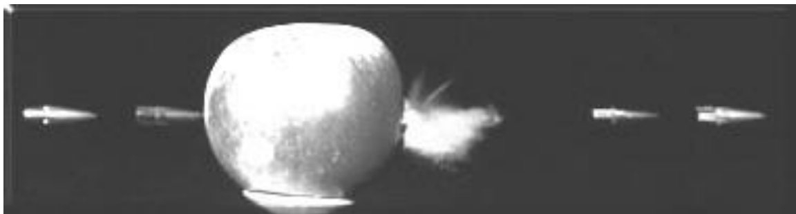
Fig. 21.2. Fotografi som visar hur en gevärskula med hastigheten 800 m/s genomtränger ett äpple. Bilden togs med en vanlig kamera vars slutare var öppen under hela exponeringsförloppet. Som ljuskälla användes ett blyxtaggregat som gav ca. 0.5 \mu s långa blyxtar som upprepades med ca. 100 \mu s tidsintervall.
