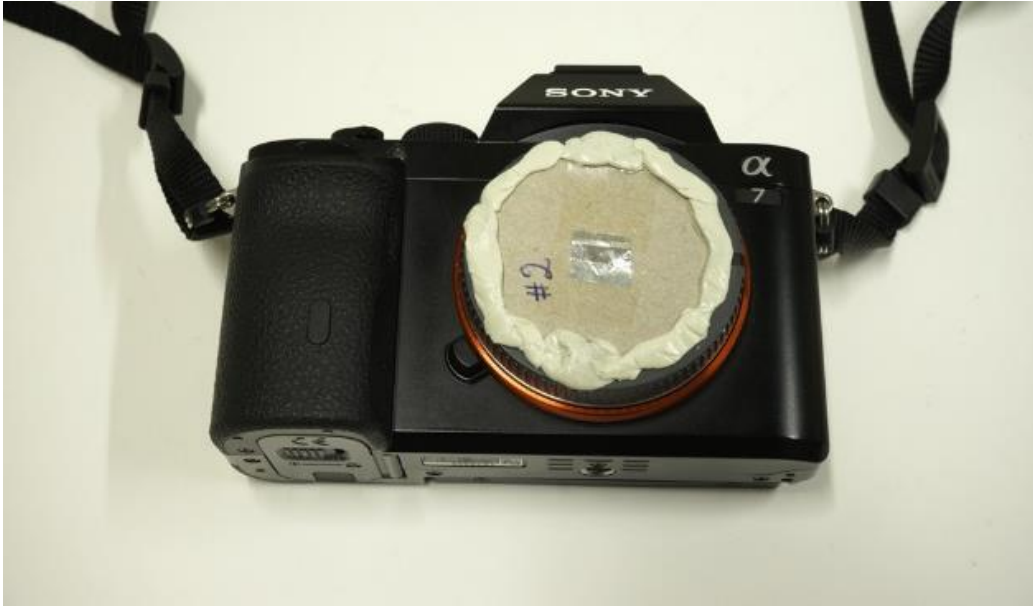
Fig. 2.4. Ett kamerahus till en SONY α7 (fullformatsensor, 24 mm x 36 mm, med 24 Mpixlar) har byggts om till en hålkamera. Ett 0.2 mm hål gjordes i en Al-folie (vanlig kökstyp) genom att sticka en vass synål en liten bit in i folien. Denna folie tejpades sedan på en kartongbit som fästes med häftmassa (ljustätt!) på locket till kamerahuset (ett hål hade gjorts i locket). Det lilla hålet hamnade då ca. 24 mm från sensorn, vilket gör att bilderna uppvisar kraftig vidvinkleffekt (se kap. 6).
