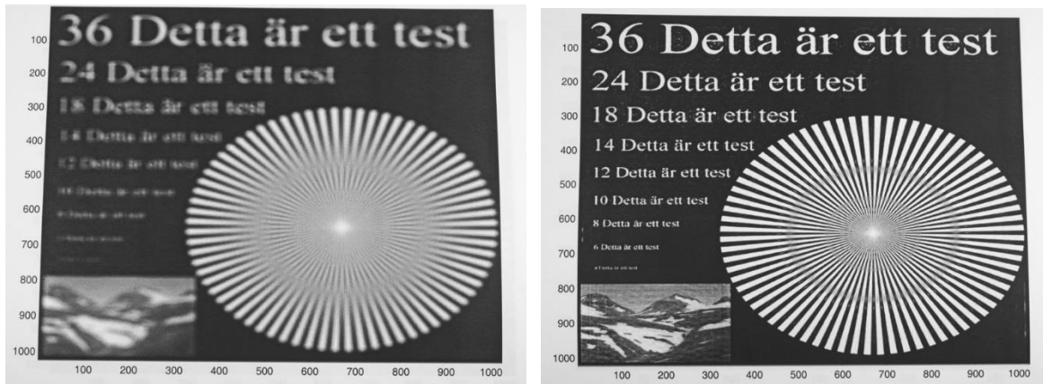
Fig. 17.32. Vänstra figuren visar en bild som erhållits då optiken varit felfokuserad. Bilden är allmänt suddig, och för vissa tätheter i "ekermönstret" försvinner kontrasten helt för att sedan återuppstå (men då har vita och svarta linjer bytt plats). Högra figuren visar samma bild efter avfaltung. Förutom att skärpan är mycket bättre, så ligger svarta och vita linjer på sin rätta plats. Vid linjetätheter där den vänstra figuren helt saknar kontrast kvarstår av naturliga skäl vissa felaktigheter. (Bildmaterialet har erhållits från Anna Burvall och Peter Unsbo.)
