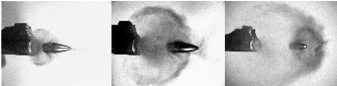
Fig. 21.1. Bildsekvens som visar hur en kula lämnar mynningen på ett vapen. Sekvensen har tagits med en videokamera som tillåter upp till 10 miljoner bilder per sekund.
