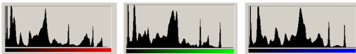
Fig. 13.9. Exempel på histogram för en bilds röda, gröna och blå färgkanaler (i den ordningen från vänster till höger). I detta fall är vitbalansen korrekt inställd, vilket ger en korrekt exponering i samtliga kanaler (jämför Fig. 11.2)
