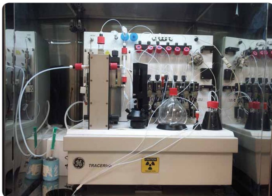
Obr. 1. Syntézní modul GE Tracerlab FXC používaný k syntéze [ ^{11}\text{C} ]methioninu. Zdroj [36].
