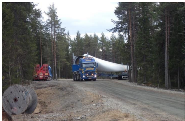
Kuva 5-7. Vasemmalla esimerkki tuulivoimapuiston rakennus- ja huoltotiestä. Oikealla tuulivoimalan osia kuljetetaan erikoiskuljetuksina (Ville Suorsa, FCG).
